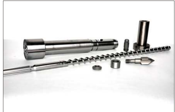
Schnecke, Schneckenzylinder, Offene Düse mit Düsen spitze und Rückstromsperre
